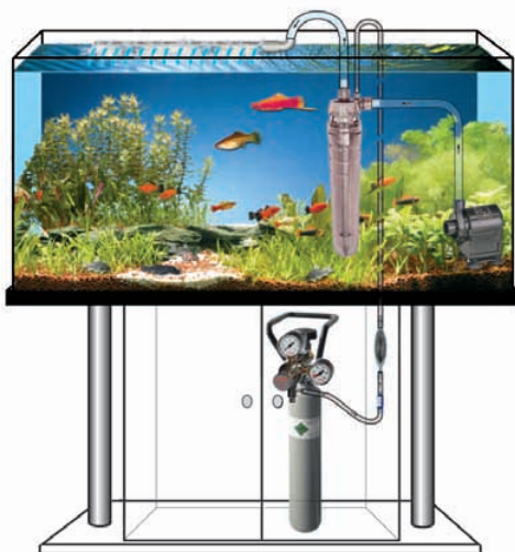
Instalace uvnitř akvária se samostatným čerpadlem
