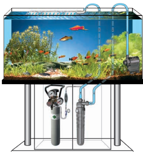
Instalace pod akvárium se samostatným čerpadlem uvnitř akvária
